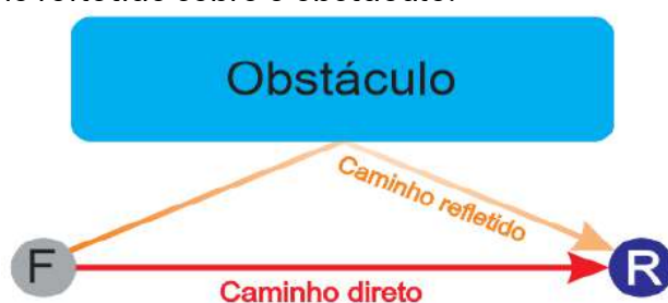
Figura 4 - Propagação do som entre uma fonte F e um receptor R, com reflexões de primeira ordem.
